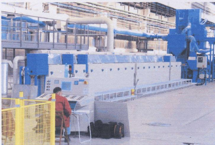
läuft der zu behandelnde Draht mit einer Geschwindigkeit von 60 m/min. durch die Anlage, egal bei welchem Drahtdurchmesser. Die Kapazität der 1-adrigen Drahtanlage mit  $\varnothing$  20 mm liegt bei 8,8 t/h, die der 36-adrigen Anlage mit  $\varnothing$  3,0 mm bei 7,1 t/h.
